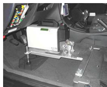
Control esfuerzo y recorrido del pedal de freno
